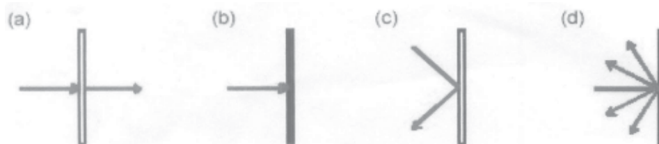
Fig 1: Sound/Surface Interaction: (a) transmission, (b) absorption, (c) reflection, (d) diffusion
